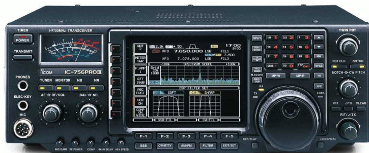
Abbildung H.14: Kurzwellen-Amateurfunkgerät 2005 , vom Typ ICOM 756. Computergesteuert, Farbbildschirm, Echtzeit-Spectrum-Analyzer, digitale Signal-Verarbeitung, Bildschirmausgabe für Funkfern-schreib-Übertragungen u.a.; das Gerät kann vollständig ferngesteuert werden. [ http://www.comdac.com/icom/756proiii.jpg ]
