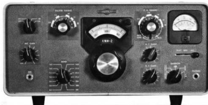
Abbildung H.12: Kurzwellen-Amateurfunkgerät 1959 , vom Typ Collins KWM 2, vollständig mit Röhren bestückt. Legendär waren und sind die elektromechanischen "Collins-Filter", die eine sehr hohe Trennschärfe haben. Viele der alten Röhrengeräte sind heute noch im Einsatz. Sie sind sehr robust, auf dem Gebrauchtmrkt preiswert zu haben und ein Funkamateurl kann sie im Gegensatz zu den heutigen hoch-integrierten Schaltungen meist selbst reparieren. [ http://www.rigpix.com/collins/kwm2.jpg ]
