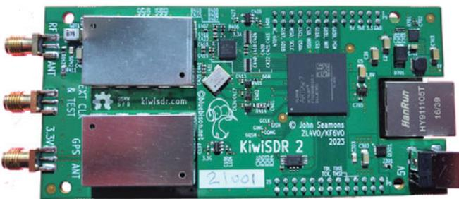
Gasentladungsröhre für einen besseren Eingangsschutz, einen neuen GPS-Chip und einen besseren Schutz gegen die Verpolung der Versorgungsspannung. Bereits heute steht eine Vielzahl an KiwiSDR v1 zur Verfügung, über die man remote zugreifen kann.
